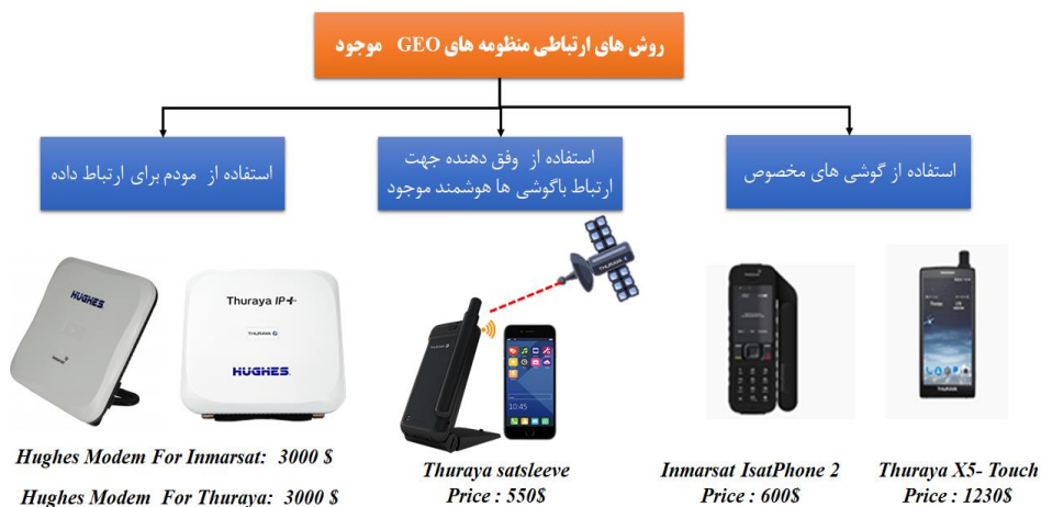
شکل ۲-۳- سه نوع تجهیز برای ارتباط با منظومه‌های ماهواره ژئو موجود [3]
